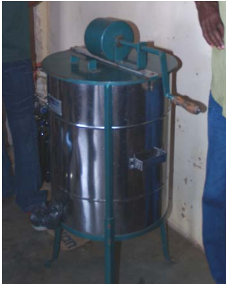
Foto: centrífugador manual de mel
